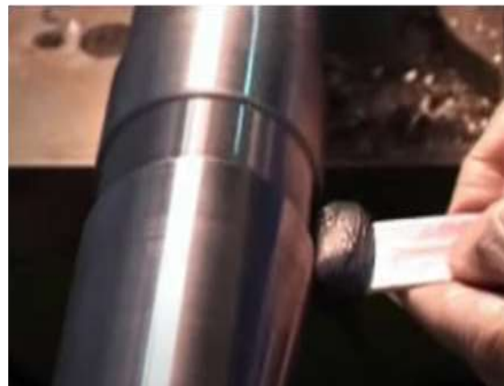
Рисунок 3.4 – Схема нанесення металополімеру шпателем.
