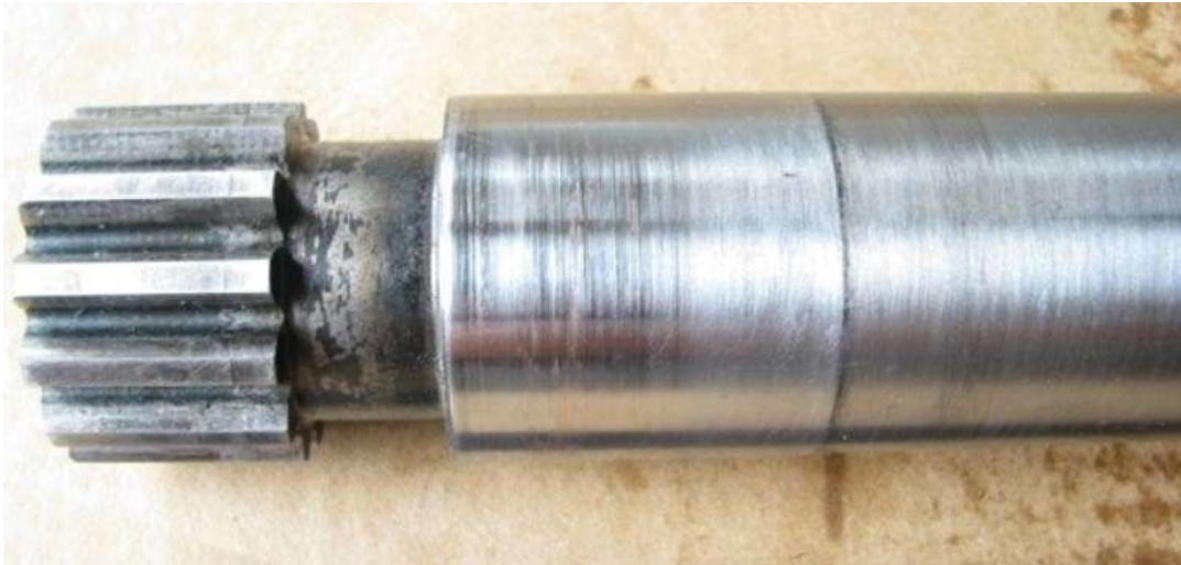
Рисунок 1.2 – Абразивний знос на опорі вала.
