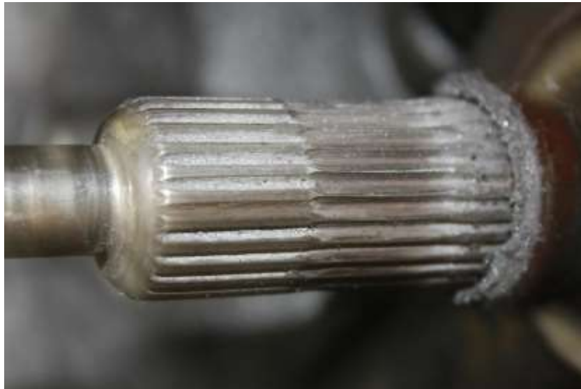
Рисунок 1.5 – Знос шліців на первинному валу коробки передач.
