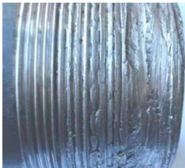
Рисунок 1.4 – Знос різьби на кінці валу.
