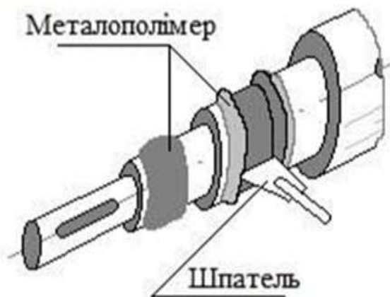
Рисунок 3.4 – Схема нанесення металополімеру шпателем.
