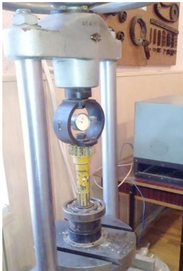
Рисунок 3.8 – Випробування підшипника на зрив з посадкового місця.
