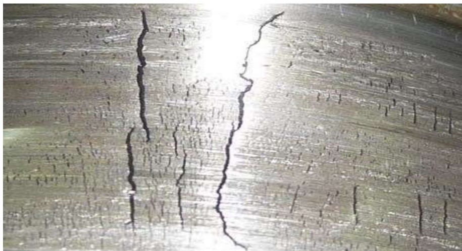
Рисунок 1.3 – Тріщини на валах.
