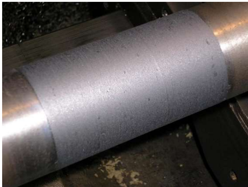
Рисунок 3.6 – Вал з нанесеним та проточеним металополімером.
