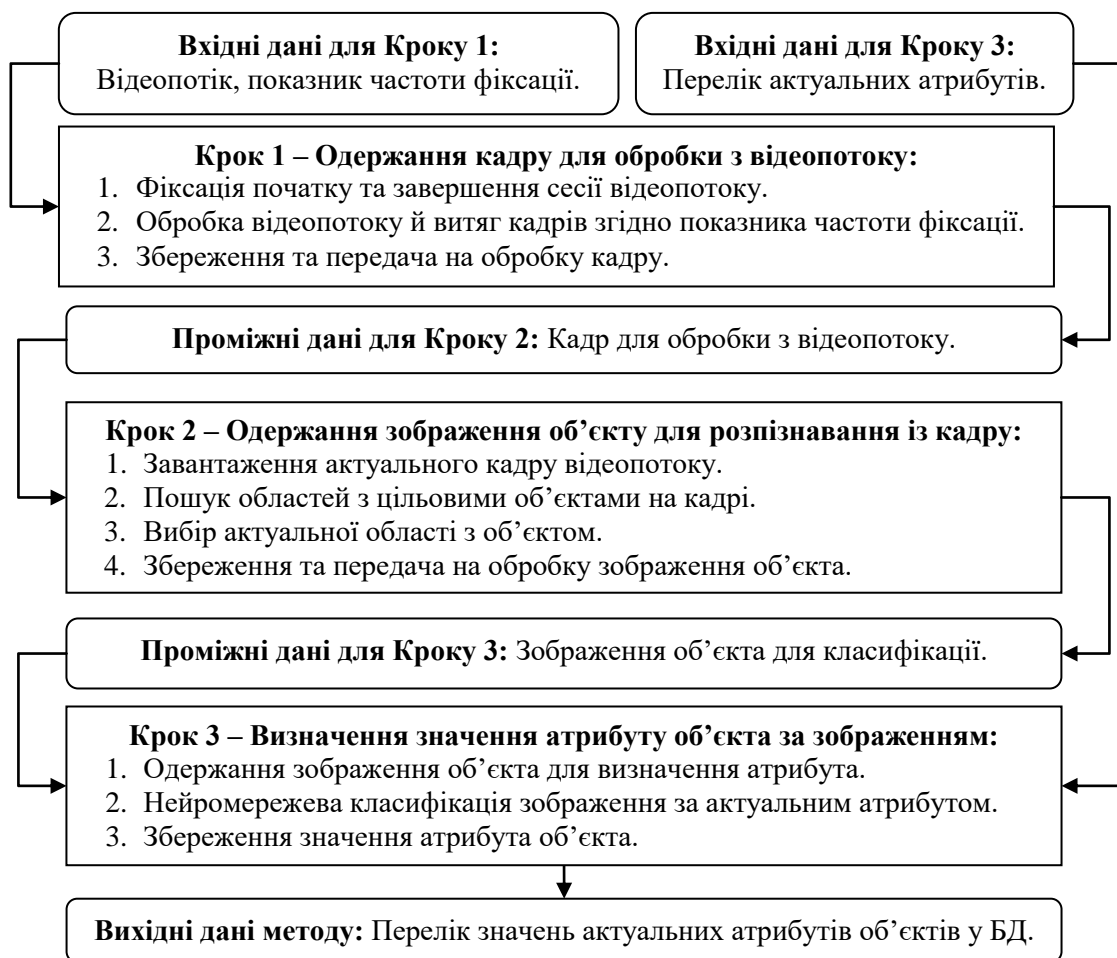
Рисунок 2.1 – Схема методу визначення значень атрибутів об'єктів нейромережевими засобами за графічними зображеннями у базах даних
