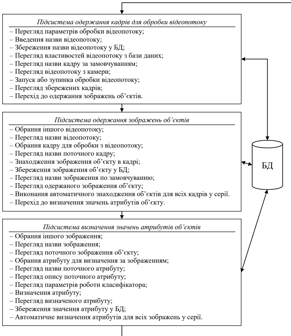
Рисунок 2.2 – Схема проектної архітектури інтелектуальної системи контролю стану працівників
