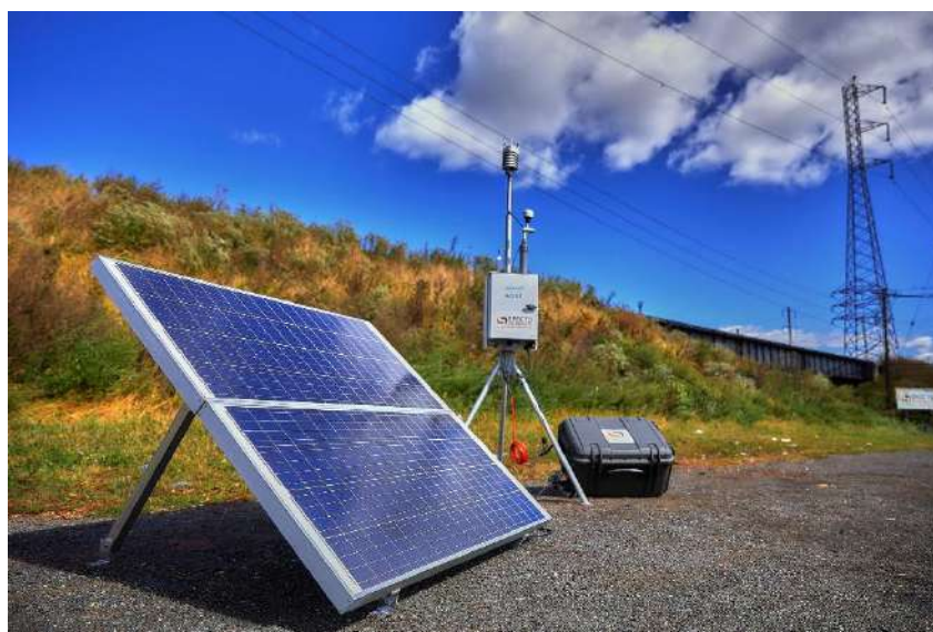
Рисунок 1.2 – Професійна метеорологічна станція [42]
