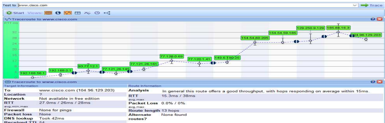
Рисунок 4.11– Трасування маршрутів за адресом www.cisco.com за допомогою програмного забезпечення Visual Route
