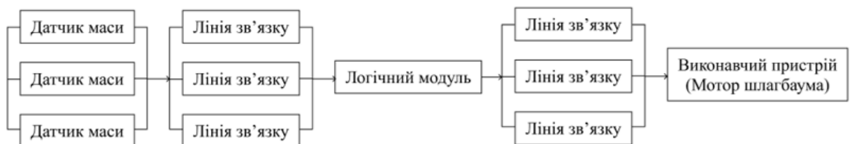
Рисунок 8 – Структурно-функціональна схема контуру вимірювання значення ваги підсистеми визначення габаритних та вагових параметрів транспорту з резервуванням за архітектурою 2oo3
