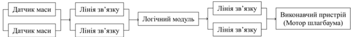
Рисунок 7 – Структурно-функціональна схема контуру вимірювання значення ваги підсистеми визначення габаритних та вагових параметрів транспорту з резервуванням за архітектурою 1oo2
