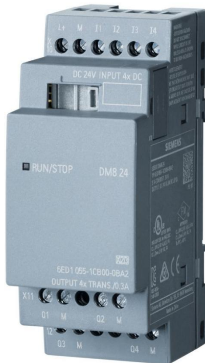
Рисунок 3.8 – Дискретний модуль розширення 6ED1055-1CB00-0BA2 LOGO! DM8 24
