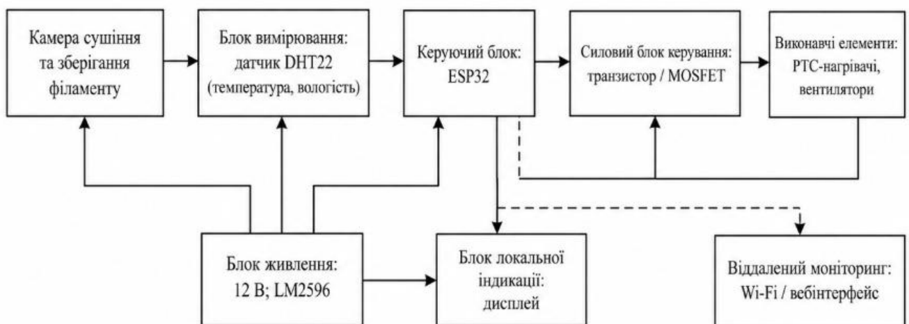
Рисунок 2.2 – Структурна схема кіберфізичної системи сушіння та зберігання філаменту
