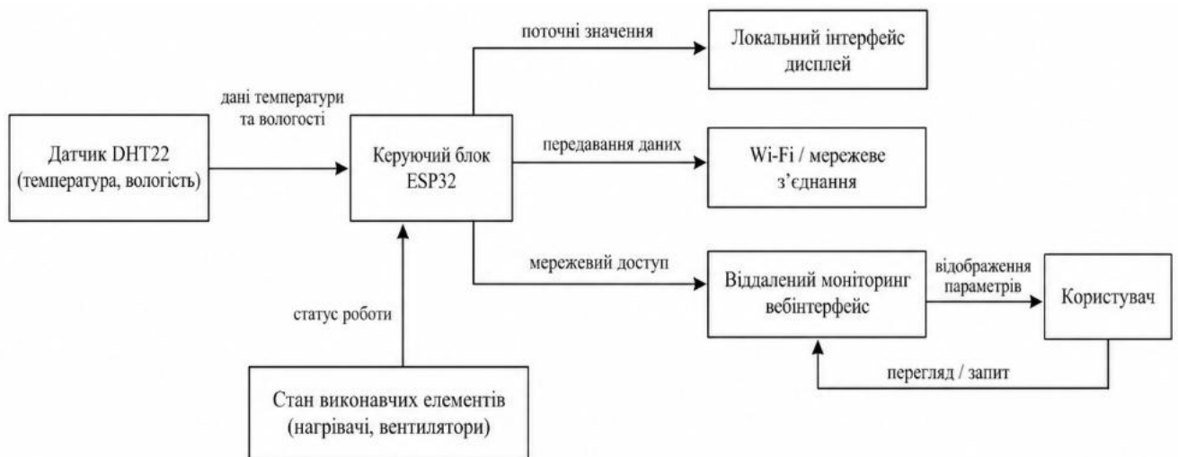
Рисунок 2.4 – Схема передавання даних у системі віддаленого моніторингу сушіння та зберігання філаменту
