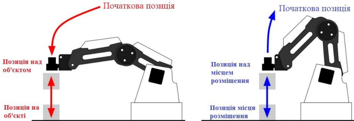
Рисунок 3.9 - Координати для кожної позиції Dobot Magician
