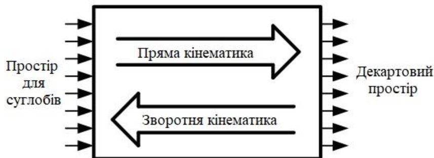
Рисунок 2.1 - Зв'язок між прямою кінематикою та зворотною кінематикою
