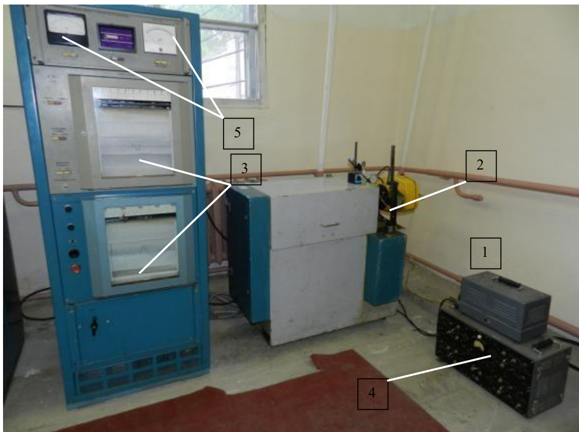
Рисунок 4.6 Комплекс для проведення триботехнічних досліджень 1 – машина тертя СМТ-1; 2 – вузол тертя; 3 – КСП-4; 4 – тензопідсилювач 8АНЧ-7М; 5 – прилади для контролю за частотою обертання та
