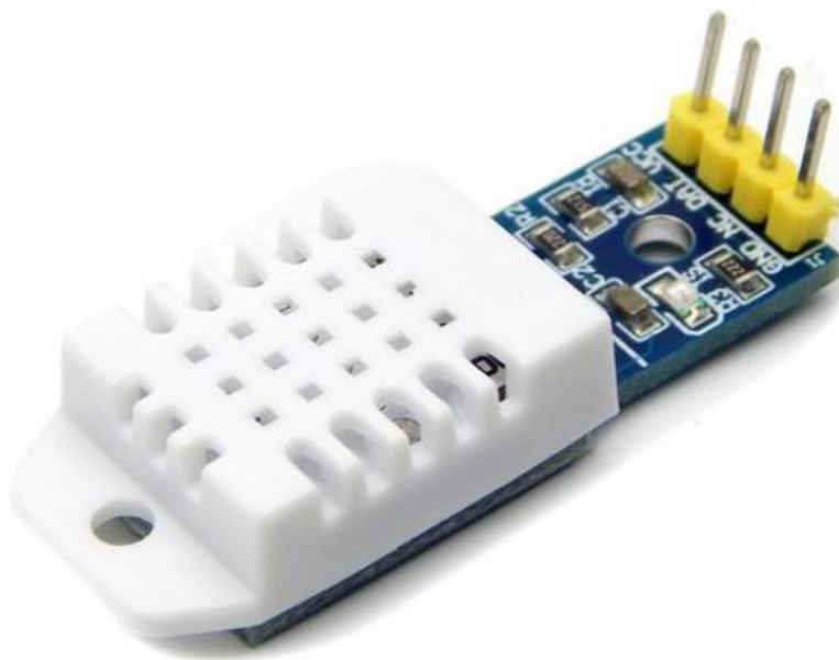
Рисунок 2.3 – Датчик температури та вологості DHT22 [22]
