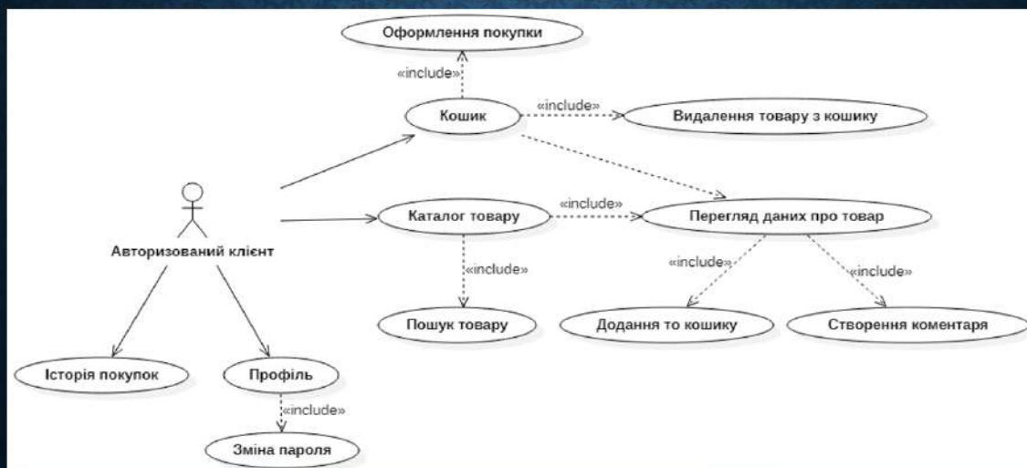
Рисунок А.6 - Діаграма варіантів використання (zareєстрований користувач)
