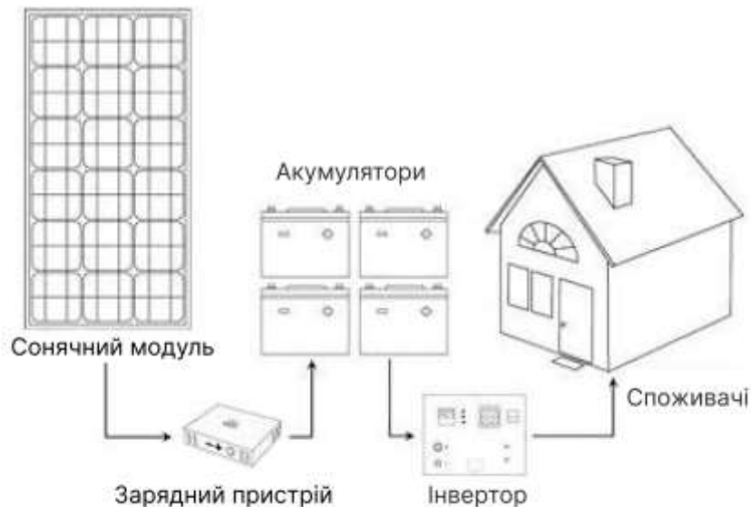
Рисунок 1.3 - Сонячна електростанція (СЕС) для автономного об'єкта
