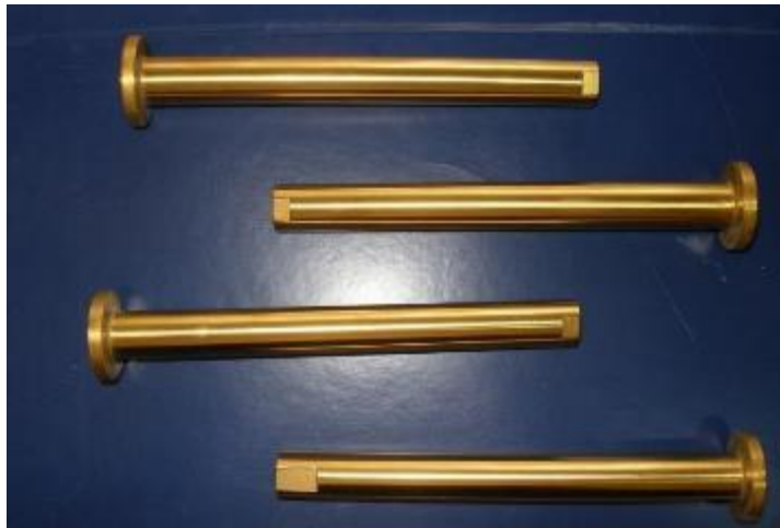
Рисунок 4.2 - Деталі системи віброізоляції тренажера БД-2 – вихідні і із зносостійким покриттям нітриду титану
