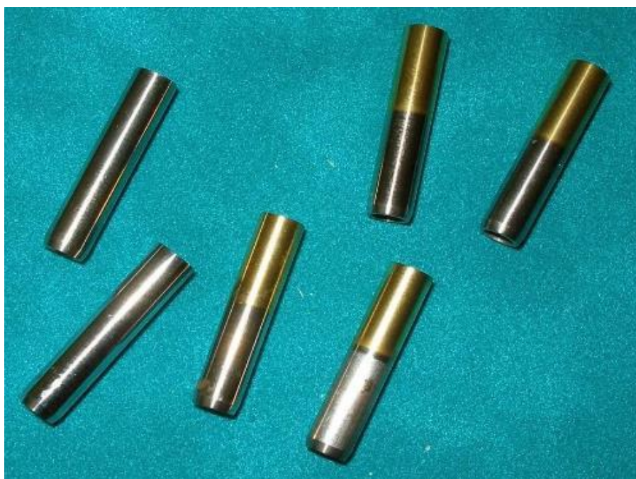
Рисунок 4.1 - Піввісь обмежувального підшипника ковзання: вихідні і з наноструктурованих покриттям нітриду титану
