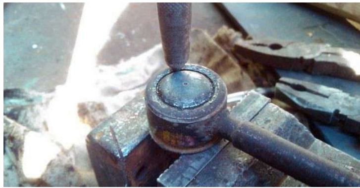
Рисунок 2.27 – Простукати корпус керном
