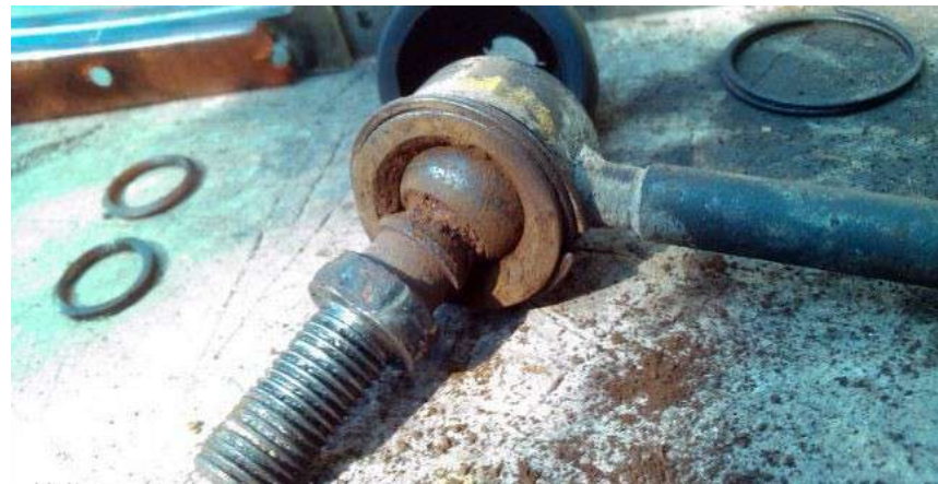
Зруйнований шарнір стабілізатора
