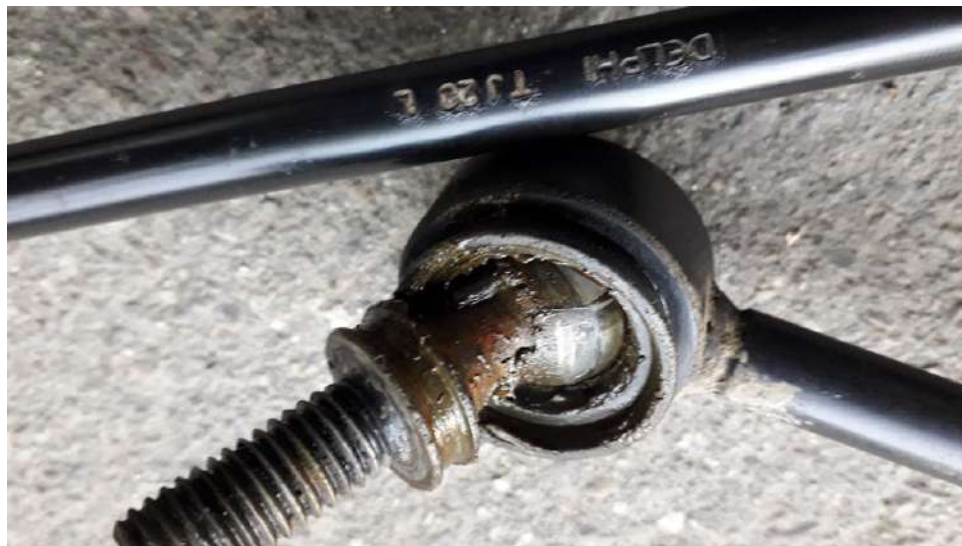
Рисунок 2.20 – Зруйнований шарнір стабілізатора
