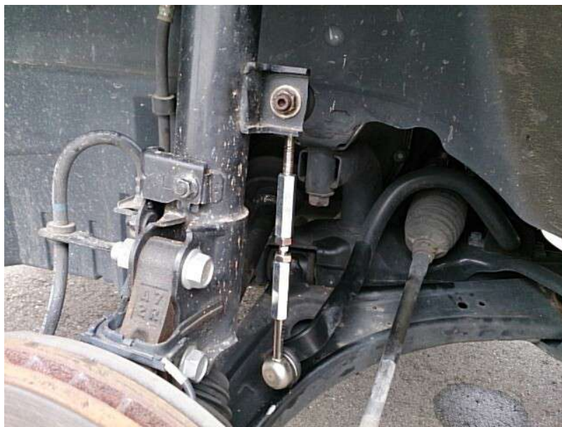
Рисунок 2.30 – Альтернативний варіант з нарізування різьблення
