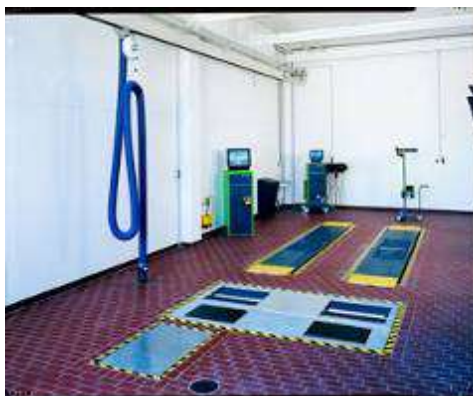
Рисунок 1.10 - Стенд для діагностики ходової частини автомобіля
