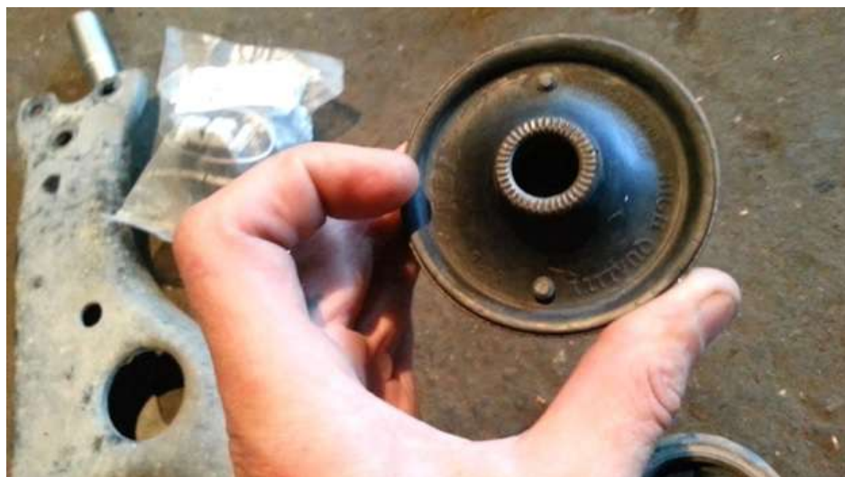
Рисунок 2.6 - Зняття та заміна сайлентблоков на Тойота Королла
