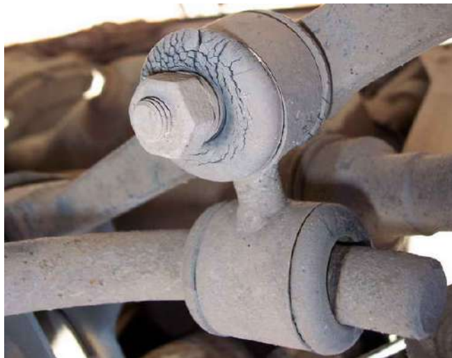
Рисунок 2.17 – Зруйнований салеинблок стабілізатора
