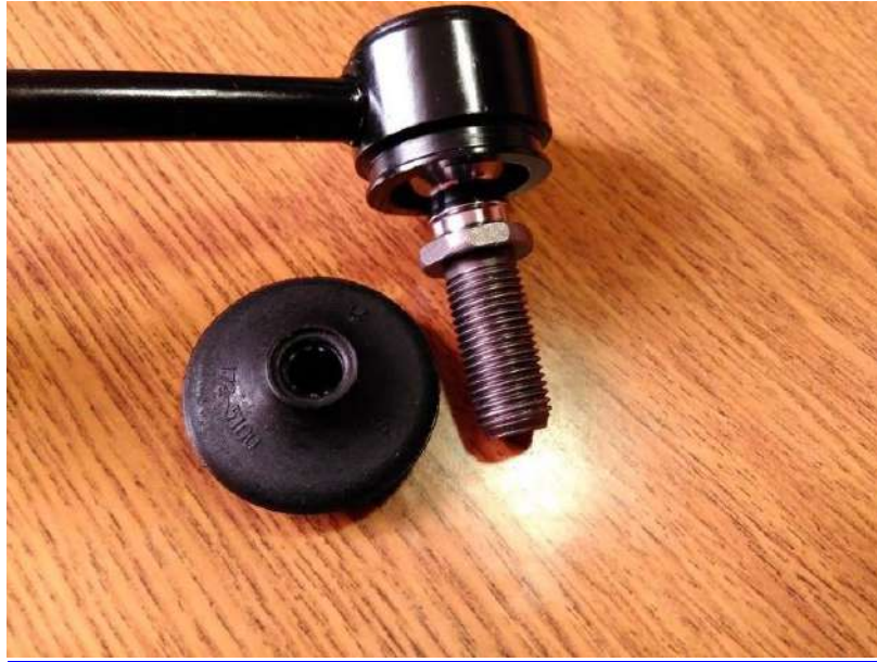
Рисунок 2.21 – Збирання стійка стабілізатора
