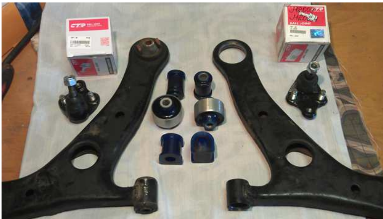
Рисунок 2.5 – Деталі передньої підвіски автомобіля Тойота Королла
