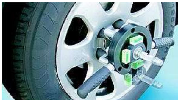
Рисунок 1.12 - Прилад для аналізу геометрії ходової частини автомобіля.
