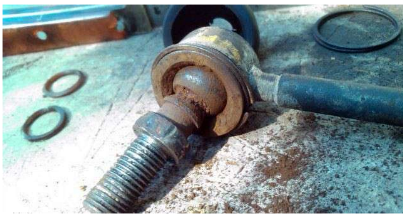
Рисунок 2.25 – Знятий пильовик стійки стабілізатора
