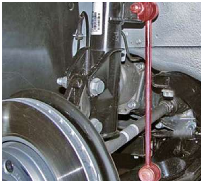
Рисунок 2.12 – Зняття стійки стабілізатора
