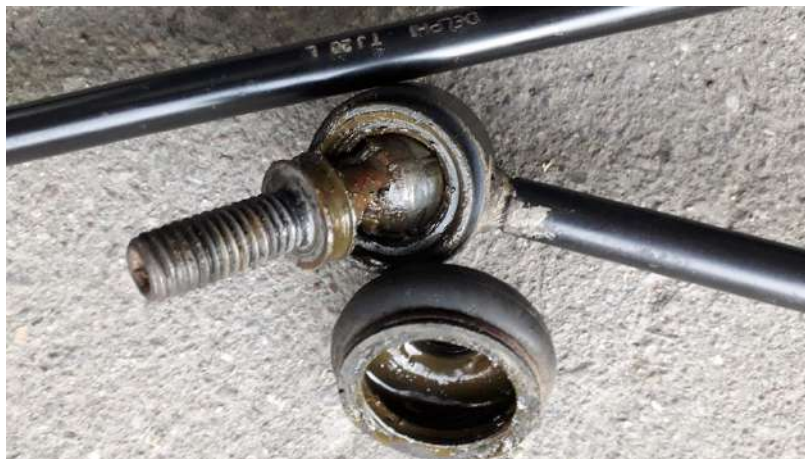
Рисунок 2.22 – Знятий пильовик стійки стабілізатора
