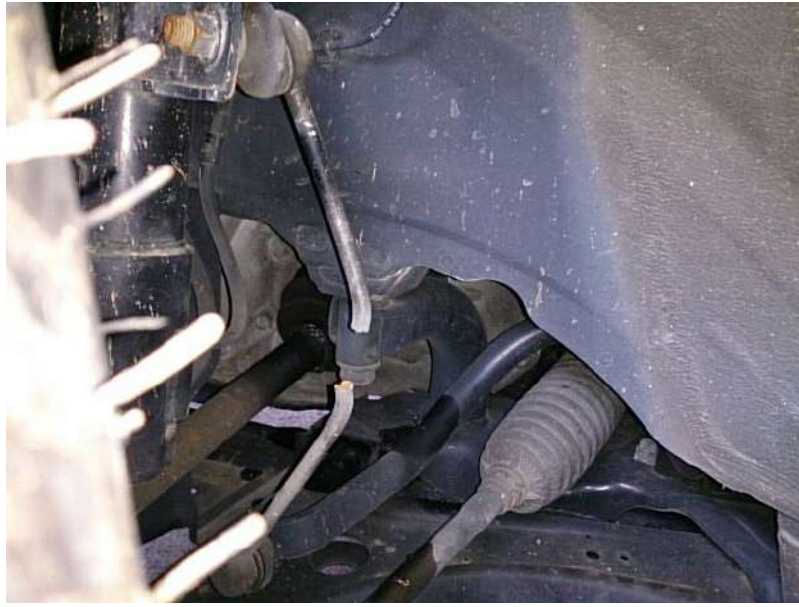
Рисунок 2.16 – Зруйнована стійка стабілізатора
