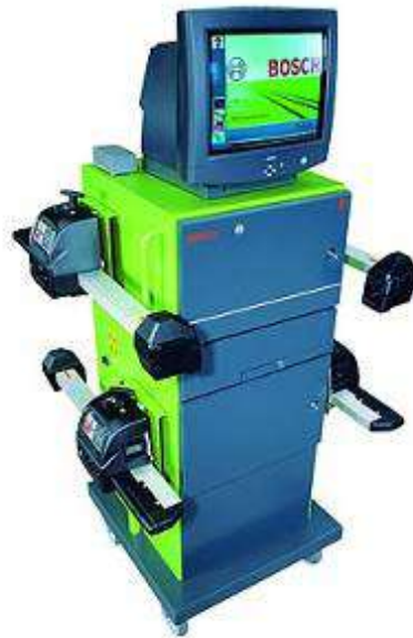
Рисунок 1.14 – Стенд аналізу геометрії ходової частини
