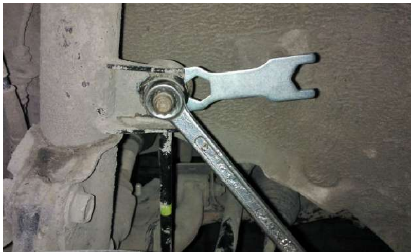
Рисунок 2.18 – Демонтаж стійки стабілізатора
