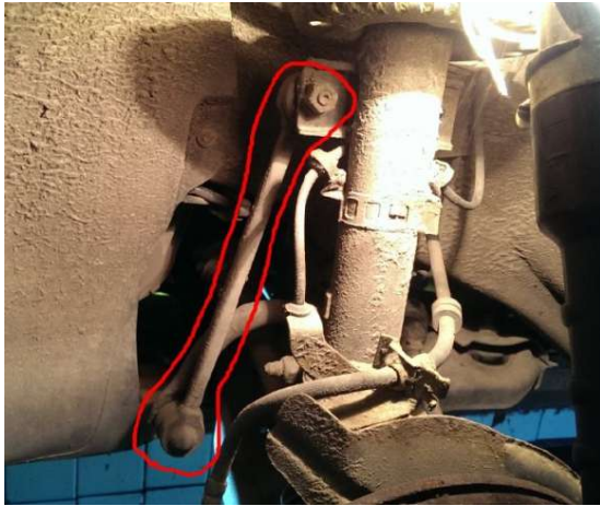
Стійки стабілізатора на автомобілі
