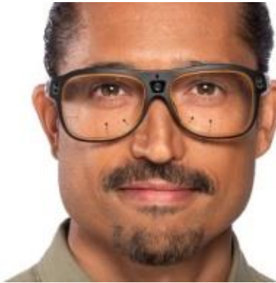
Рисунок 1.2 – Приклад використання окулярів для відстеження положення очей [3]
