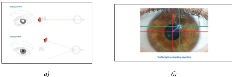
Рисунок 1.4 – Різні види конфігурацій положень камери та очей та спостереження за відбитим променем світла (справа) [3]
