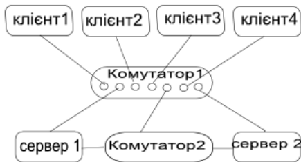
Рис. 5. Схема мережі на основі тонких клієнтів
