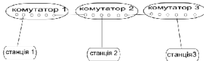
Рис. 4. Схема поєднання робочих станцій в мережу
