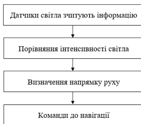
Рисунок 2.6 – Зображення прикладу логіки визначення напрямку руху на основі освітлення
