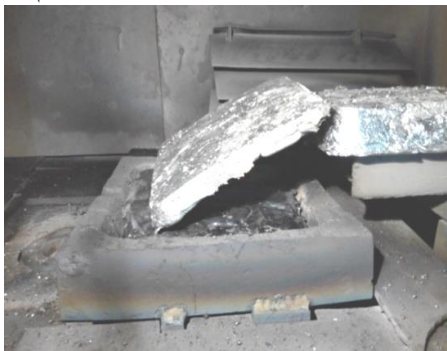
Рис. 1. Зовнішній вид пристрою для плавки лігатур з використанням бічного механізму подачі заготовки в проміжну ємність
