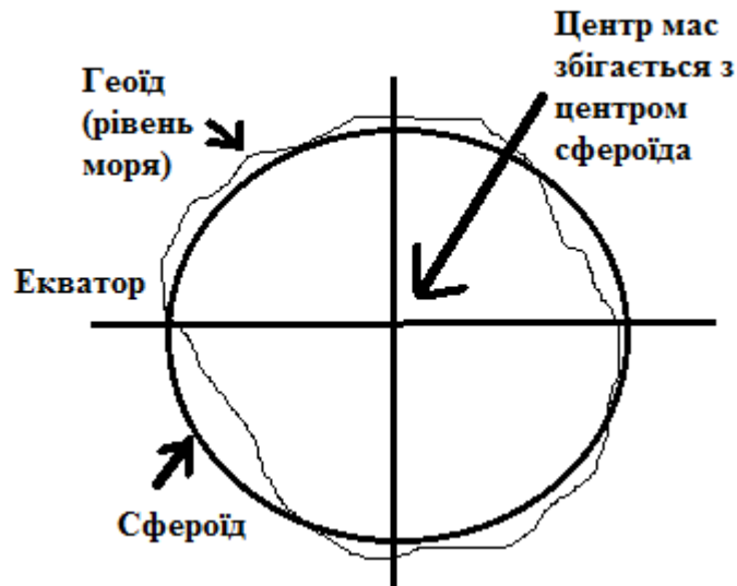
Рисунок 1.3- Перерахування відносно еталонної поверхні (тобто поверхні геоїду)
