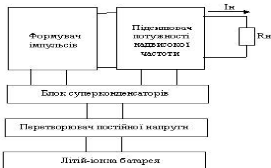
Рис. 2. Вдосконалена структурна схема генератора зондуєчих імпульсів надширокосмугових мобільних радіолокаторів із використанням блоку суперконденсаторів [4–6].
