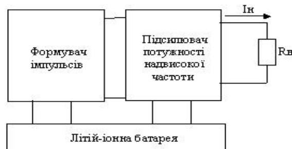
Рис. 1. Типова структурна схема генератора зондуєчих імпульсів надширокосмугових мобільних радіолокаторів
