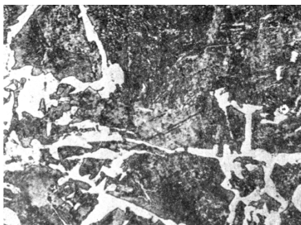
Рисунок 2.9 - Грубозерниста структура перегрітої доевтектоїдної сталі
