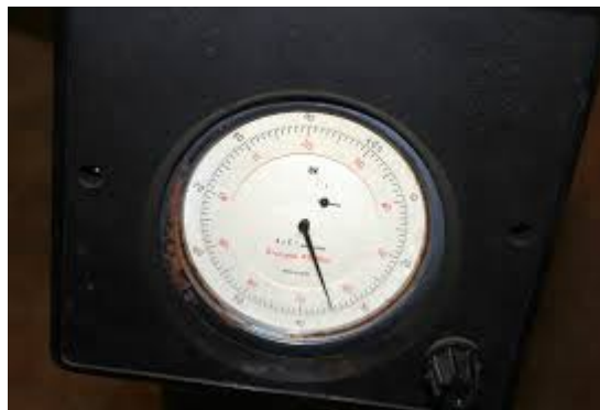
Рисунок 3.8– Індикаторна головка приладу ТР 5006 для зчитування значень твердості
