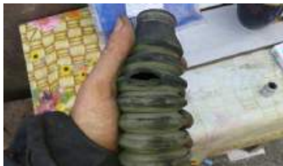
Рисунок 1.8 - Пошкодження захисного чохла
