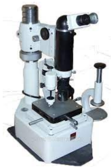
Рисунок 3.9 - Загальний вигляд приладу ПМТ-3 для вимірювання мікротвердості
