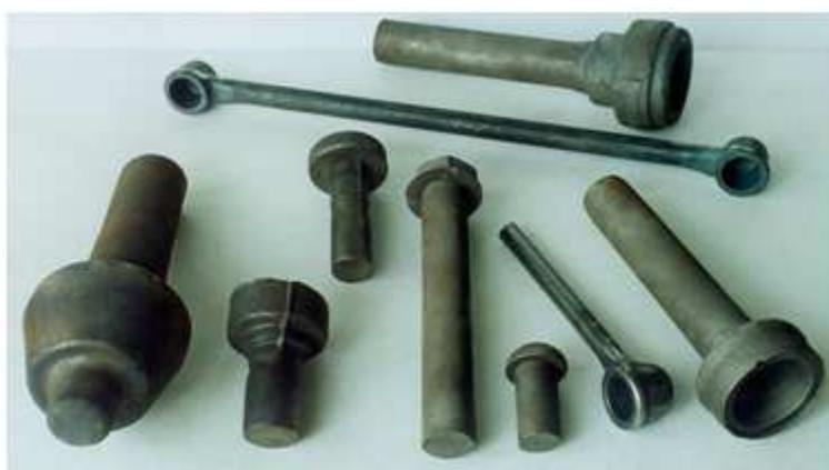
Рисунок 2.3 – Поковки, одержані на спеціалізованих горизонтально-кувальних машинах
