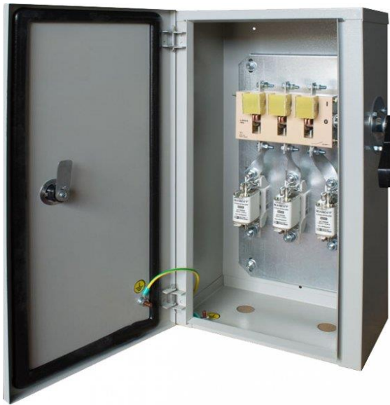
Рисунок 2.10 - Зовнішній вигляд вимикача-роз'єднувача ЯПР 100А 36 IP54 УХЛЗ з плавкими вставками ППНИ-33 г 0 50А ІЕК (DPP20-050)
