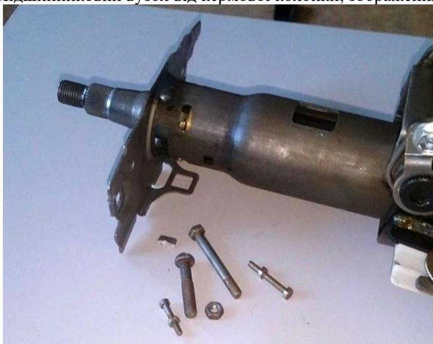
Рисунок 2.9 – Підшипниковий вузол від кермової колонки, зображення в 3D
