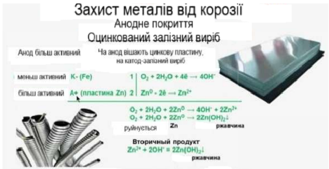
Рисунок 1.11 – Схема анодного захисту
