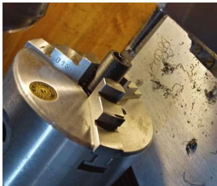
Рис 3.5 Попереднє розточування отвору у зразку для базування на оправці
