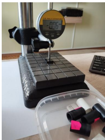
Рис. 3.20. Установка для вимірювання величини зношування зразків з пластмасових матеріалів: HIPS; CoPet; ABS
