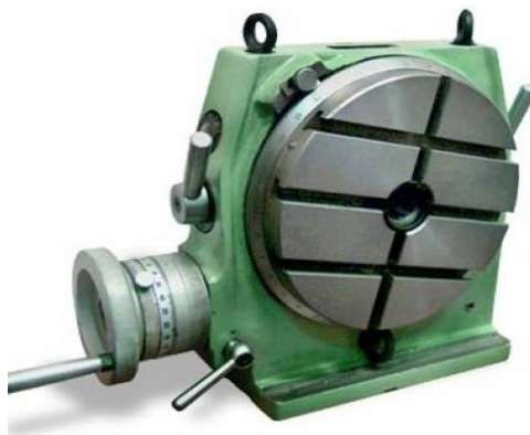
Рис. 3.22 Загальний вигляд поворотного стола із ручним приводом, що підлягає модернізації
