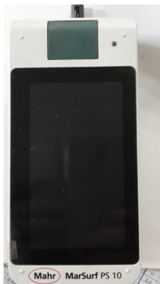
Рис. 3.19 Прилад для вимірювання шорсткості Mahr MarSurf PS 10
