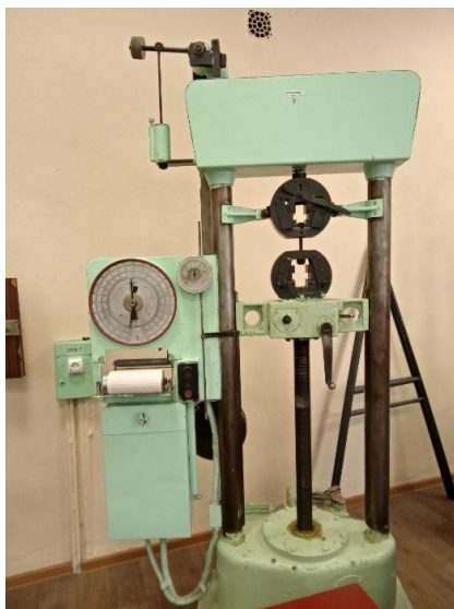
Рис. 3.10 Розривна машина УММ-5
