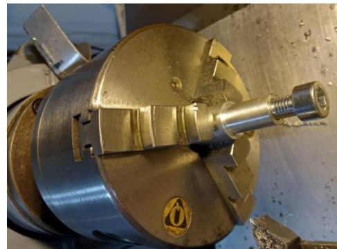
Рис. 3.6 Оправка для встановлення зразків закріплена в трикулачковому патроні
