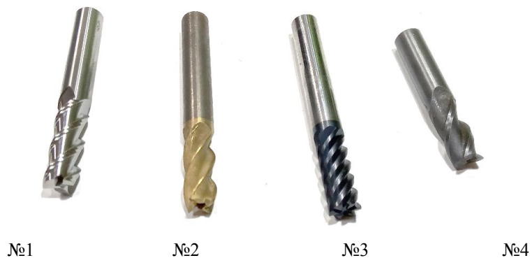
Рис. 3.8 Кінцеві фрези різної конструкції та поверхневим покриттям
