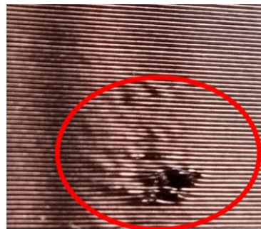
Рис. 1.8. Дефекти на вертикальних поверхнях деталі внаслідок забрудненого сопла
