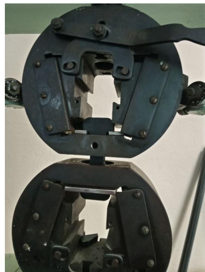
Рис. 3.11 Фіксація зразка в оснащенні машини УММ-5
