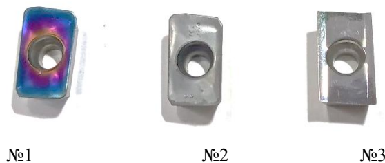
Рис. 3.9 Змінні пластинки для встановлення у корпусі торцевої фрези PE01.11B32.100.10
