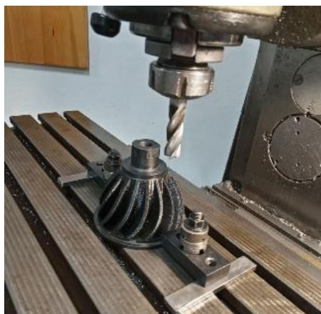
Рис. 4.7 Фрезерування лисок h
