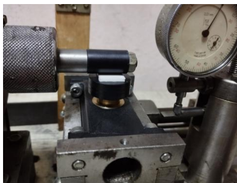
Рис. 3.17. Вигляд закріплених зразка і контртіла
