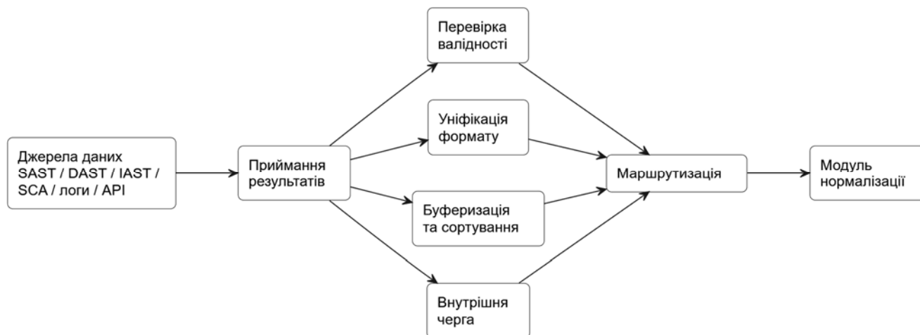
Рисунок 3.1 – Алгоритм багатоканального збору та обробки результатів сканування.
