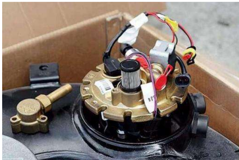
Рисунок 1.15 - Газовий насос Vialle із вбудованим фільтром грубого очищення газового палива
