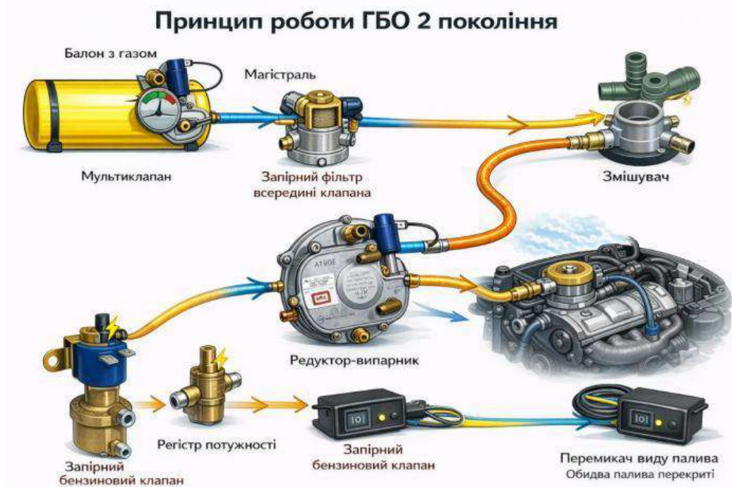
Рисунок 1.7 - Схема роботи ГБО 2 покоління
