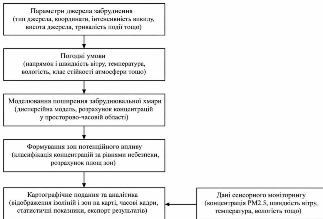
Рисунок 2.1 – Загальна схема функціонування інформаційної системи моніторингу та моделювання поширення атмосферних забруднень
