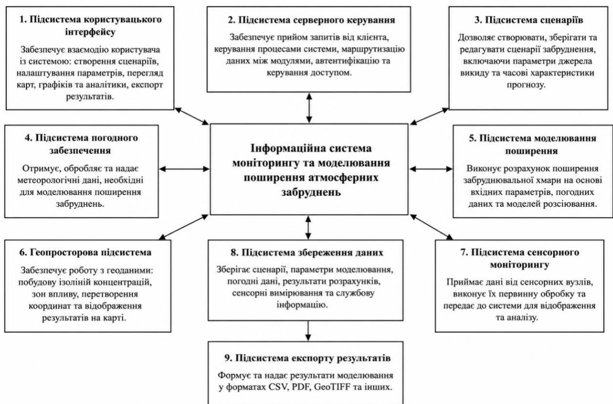
Рисунок 2.3 – Основні програмні підсистеми інформаційної системи моніторингу та моделювання поширення атмосферних забруднень
