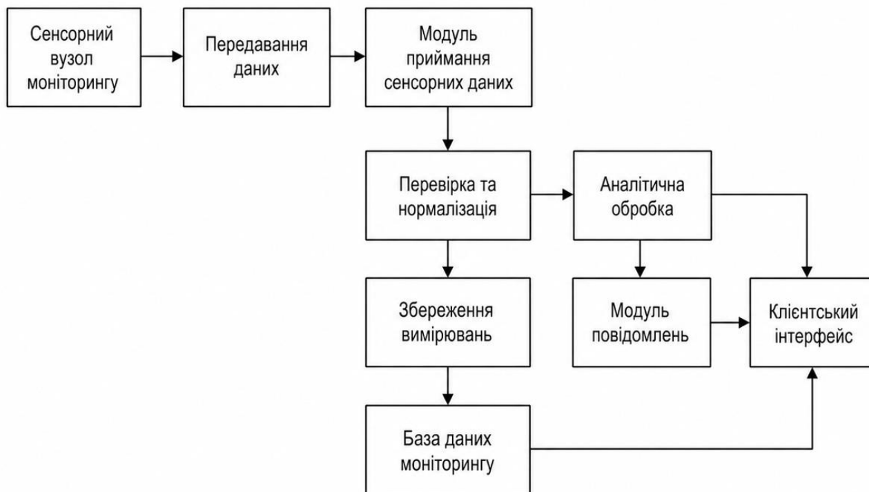
Рисунок 2.7 – Архітектура програмного забезпечення складової системи моніторингу атмосферних забруднень
