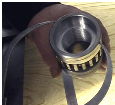
Рисунок 29 – Вимірювання зовнішніх розмірів деталі кронциркулем
