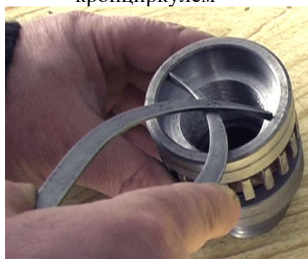
Рисунок 30 – Вимірювання внутрішніх розмірів деталі кронциркулем
