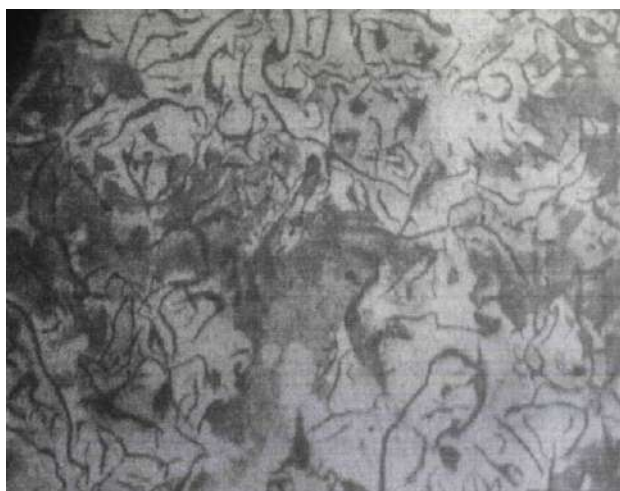
Рис. 3.3. Микроструктура чугуна СЧ20 на нетравленном шлифе, х 200
