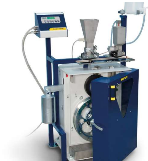
Рисунок 3.1 – Установка для випробувань на абразивний знос.
