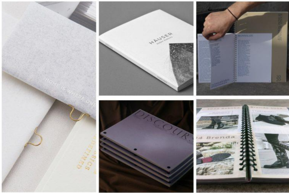
Рисунок 1.7 – Види кріплень: на скобу, на пружину, термобіндер, не приховану пружину
