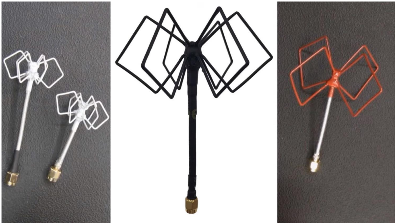
Рисунок 2.6 – Приклади всенаправлених BiQuad антен
