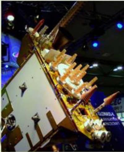
Рисунок 7. Зовнішній вигляд антенного комплексу супутнику «ГЛОНАСС-К».
