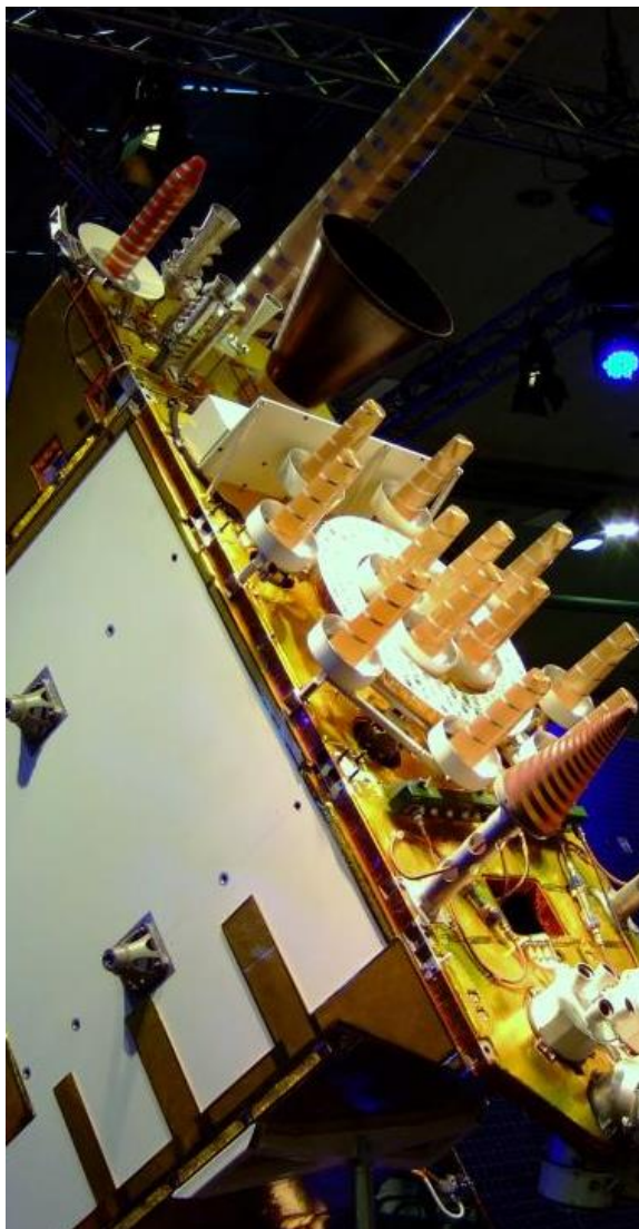
Рисунок 1.6 – Зовнішній вигляд антенного комплексу
