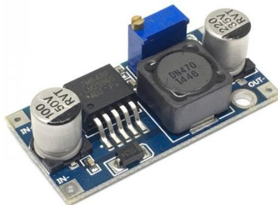
Рисунок 2.4 – Модуль перетворювача напруги LM2596
