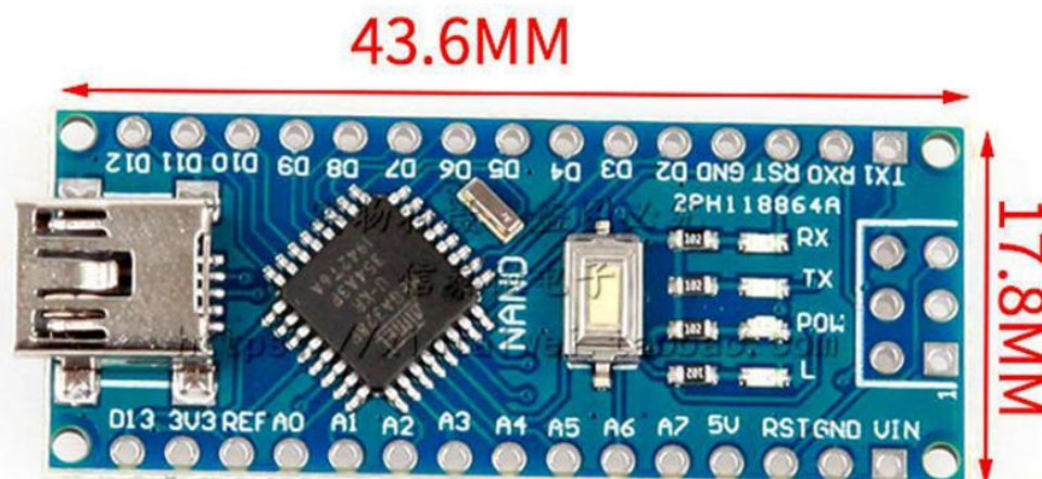
Рисунок 2.2 – Мікроконтролерна плата Arduino Nano (із вказанням геометричних розмірів)
