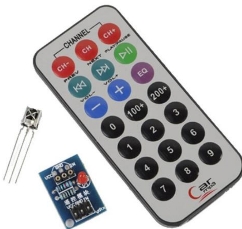
Рисунок 1.1 – ІЧ модуль управління NH1838 з пультом
