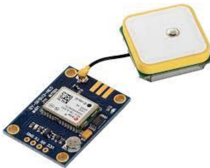
Рисунко 2.3 – GPS модуль Neo-6M (з антеною)
