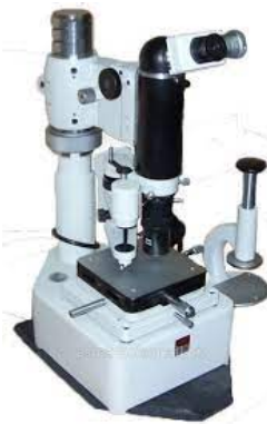
Загальний вигляд приладу ПМТ-3 для вимірювання мікротвердості
