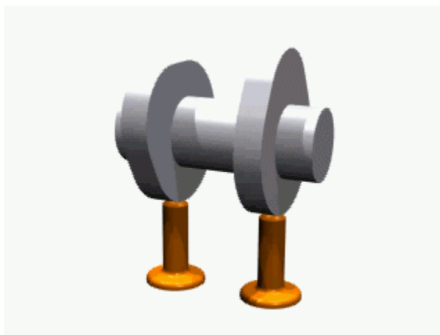
Рисунок 1.4 Принцип роботи розподільчого валу
