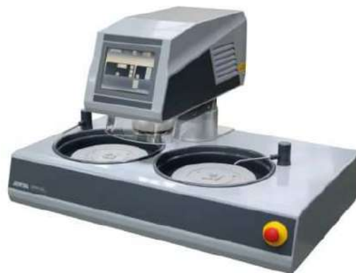
Рисунок 3.2 - Зовнішній вигляд установки для приготування мікрошліфів
