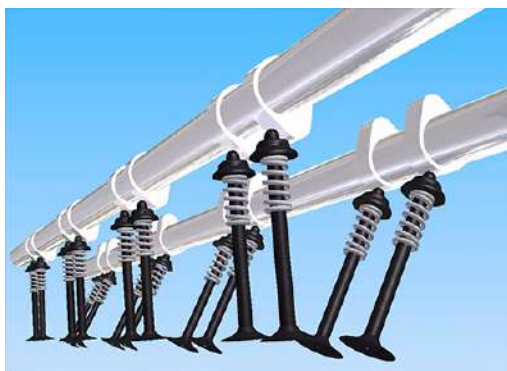
Рисунок 1.6 - Модель використання 2 –х розподільчих валів
