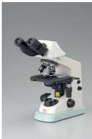
Рисунок 3.3 - Загальний вигляд оптичного мікроскопу MMP-2 для проведення мікроструктурних досліджень
