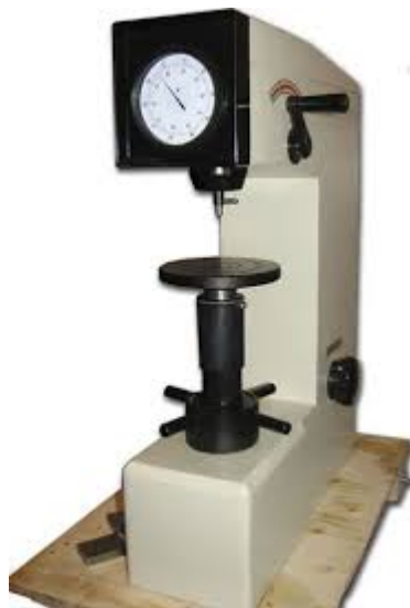
Рисунок 3. 6– Прилад для вимірювання твердості за методом Роквелла
