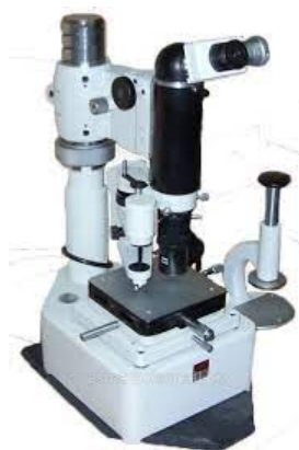
Рисунок 3.4 - Загальний вигляд приладу ПМТ-3 для вимірювання мікротвердості
