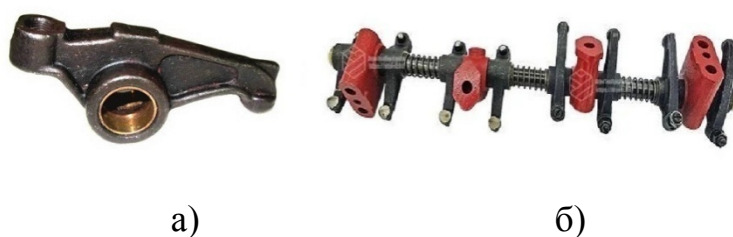
Рисунок 1.7 – Коромисло (а) та механізм коромисел в зборі (б) двигуна Д-240 (МТЗ-80)
