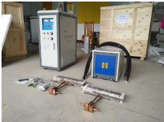
Рисунок 3.2 - Установка для індукційного нагрівання з частотою струму в межах 30 - 80 кГц, потужність від 5 до 200 кВт для термічної обробки металів, паяння, відпалу тощо.
