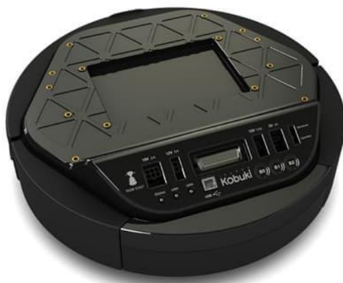
Рисунок 1.2 - Мобільна база Kobuki [6]
