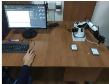
Рис. 1. Робот-маніпулятор Dobot Magician (Добот Чарівник)
