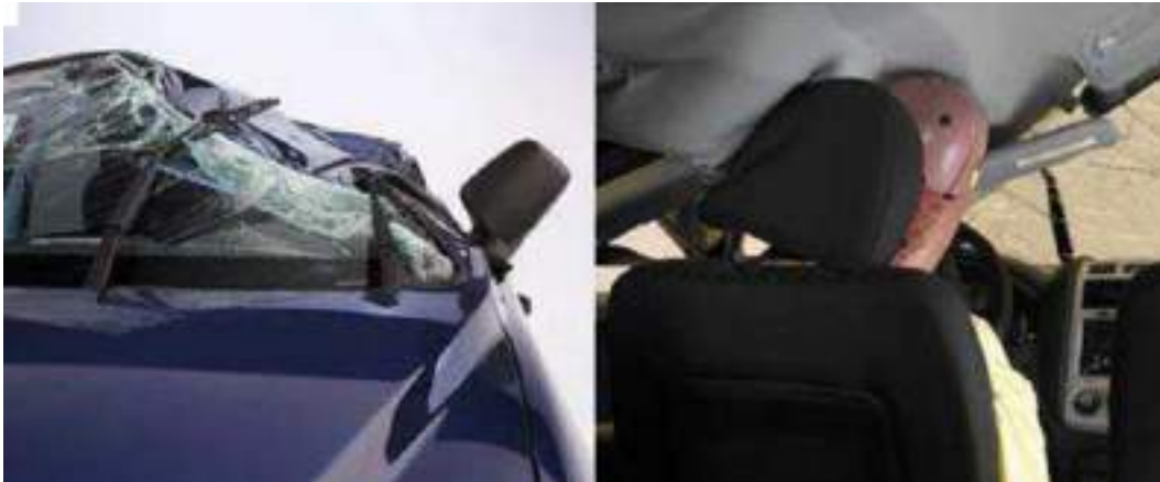
Рисунок 2.4 – Слабкі стійки даху та пошкодження голови водія
