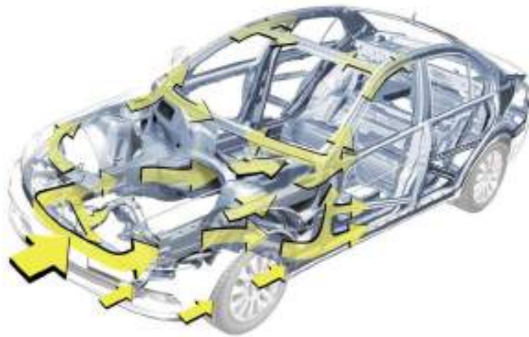
Рисунок 2.1 – Розподіл енергії удару при прямому зіткненні.
