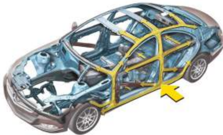
Рисунок 2.2 – Розподіл енергії удару при бічному зіткненні.
