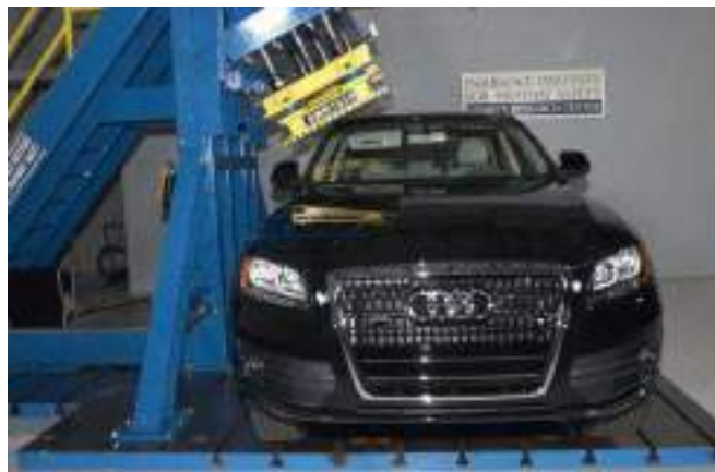
Рисунок 2.5 – Стенд перевірки міцності даху
