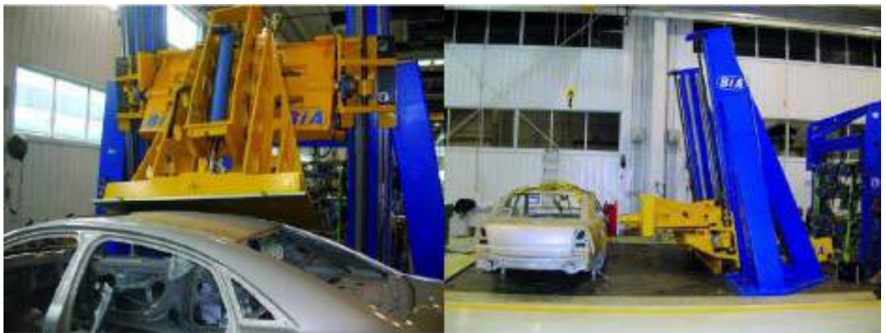
Рисунок 2.6 – Випробування міцності даху та дверей
