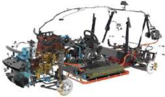
Рисунок 2.8 – Цифровий двійник внутрішніх систем автомобіля.
