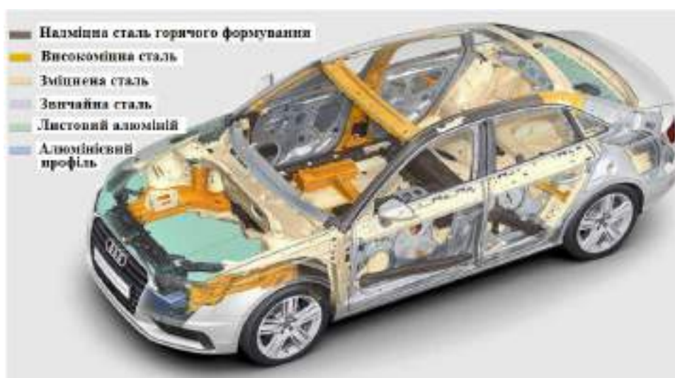
Рисунок 1.4 – Матеріали виготовлення кузова.
