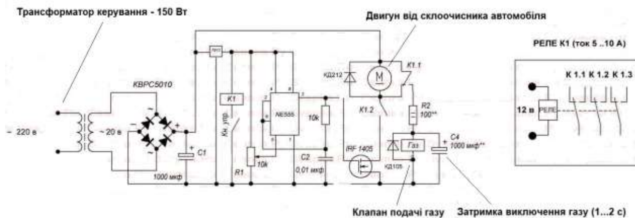
Рисунок 1.14 – Схема електрична принципова керування механізмом подачі дроту
