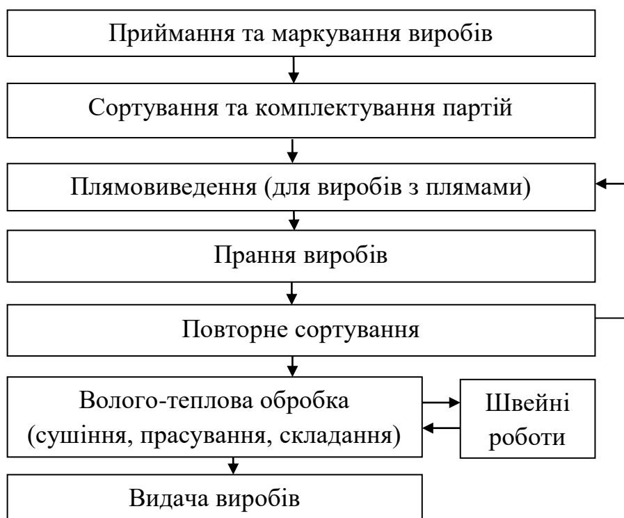
Рисунок 3.1 – Типова схема технологічного процесу прання целюлозомістких текстильних виробів
