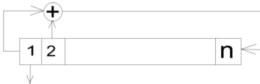
Рисунок 1.4 - Лінійний зсувний регістр зі зворотним зв'язком (LFSR)
