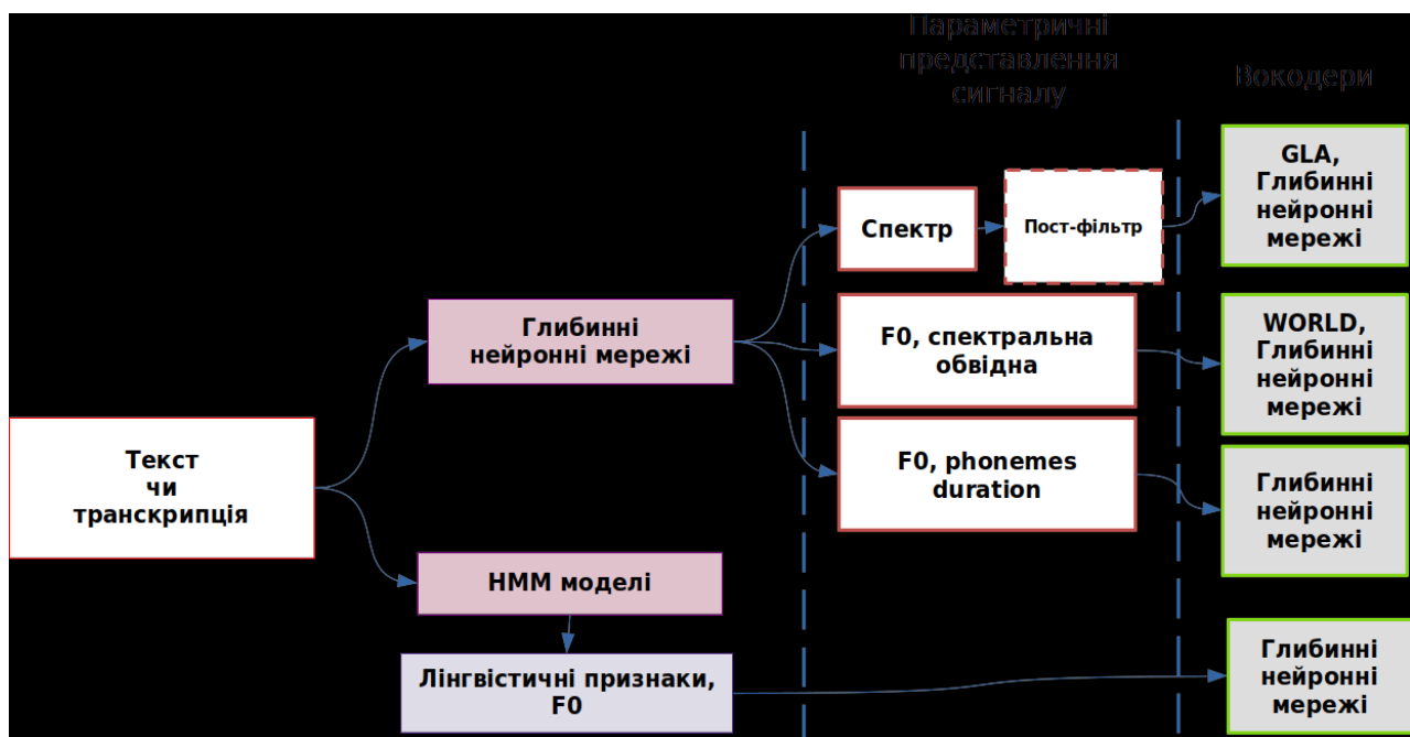
Рисунок 1.10 – Різні варіанти систем для синтезу мовлення за допомогою нейронних мереж
