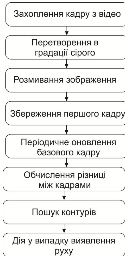
Рисунок 1.9 – Процес розпізнавання рухів із відео
