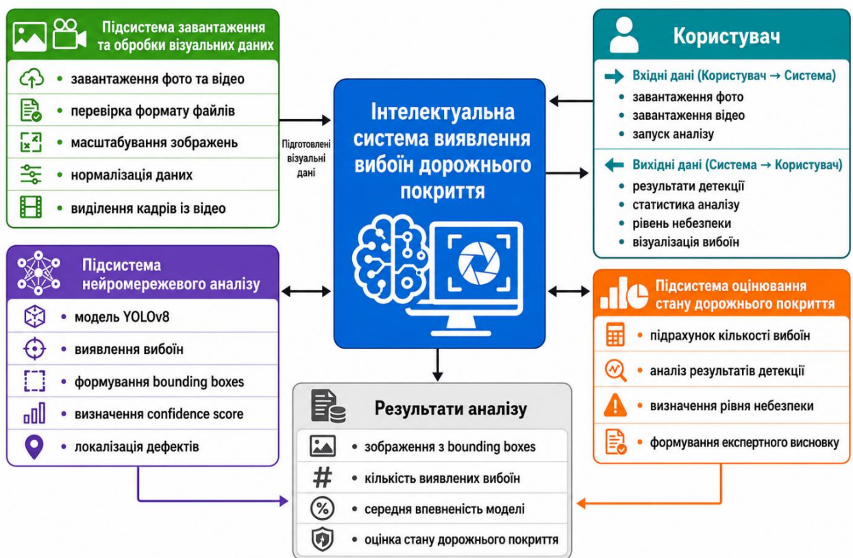
Рисунок 2.6 – Схема архітектури інтелектуальної системи виявлення вибоїв дорожнього покриття
