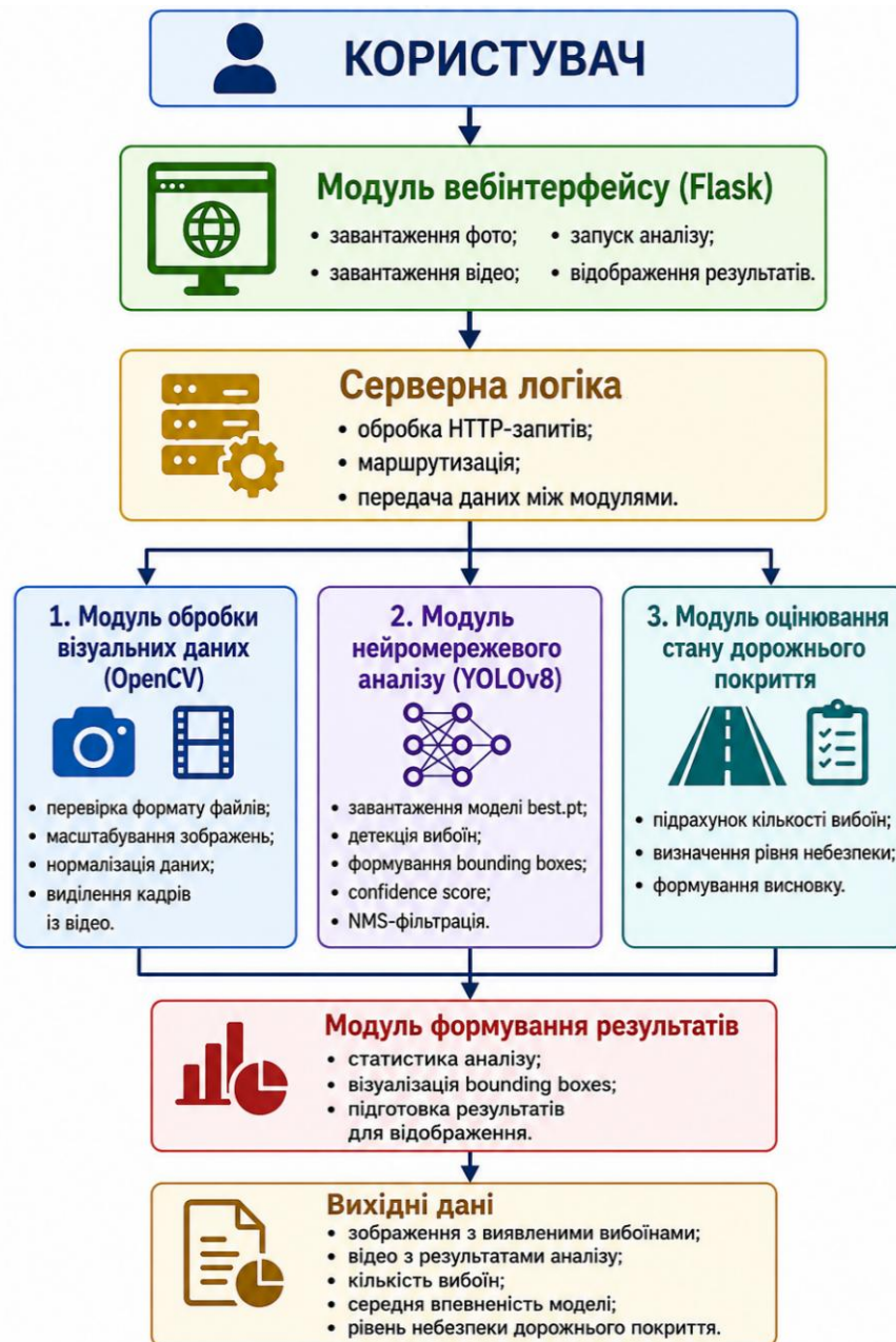
Рисунок 3.1 – Структурна схема програмних модулів інтелектуальної системи
