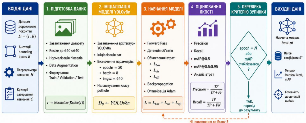
Рисунок 2.4 – Схема навчання нейромережевої моделі
