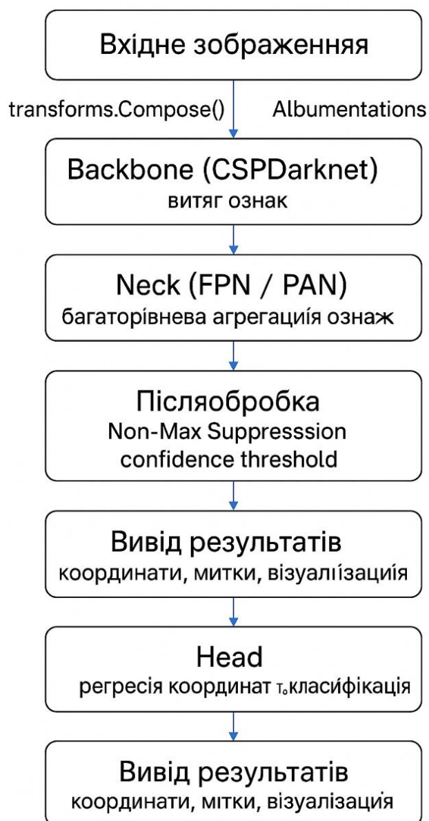
Рисунок 2.3 – Імплементация нейромережевого методу виявлення літаків у системі обробки зображень
