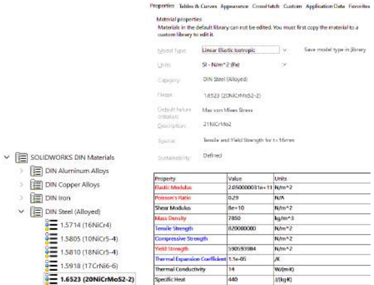
Рисунок 5.2 – Призначення матеріалу хрестовини карданної передачі
