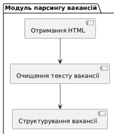
Рисунок 2.3 – Діаграма декомпозиції модуля «Парсинг вакансії»
