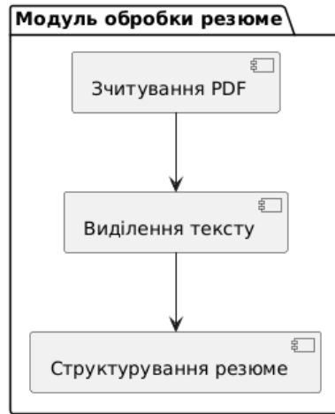
Рисунок 2.2 – Діаграма декомпозиції модуля «Обробка резюме»
