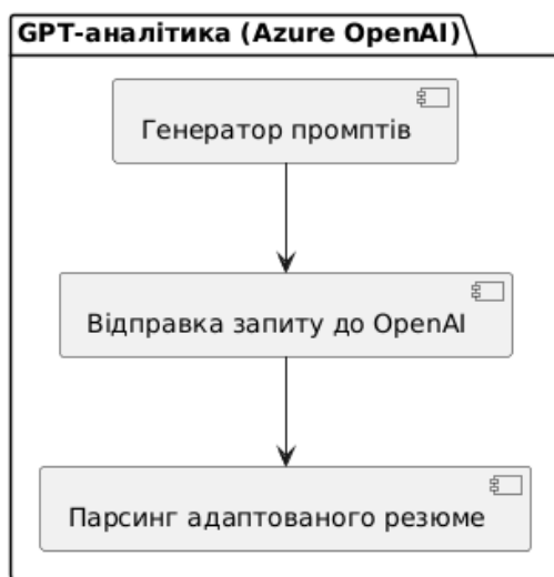
Рисунок 2.4 – Діаграма декомпозиції модуля «Адаптація (GPT-аналітика)»
