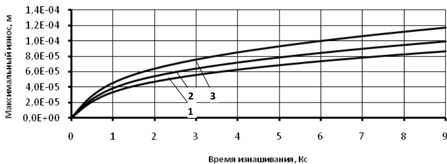
Рис. 5 – Зависимость максимального износа от времени изнашивания при перекосе оси вала и втулки: 1 – 0,35^\circ ; 2 – 0,5^\circ ; 3 – 0,75^\circ
