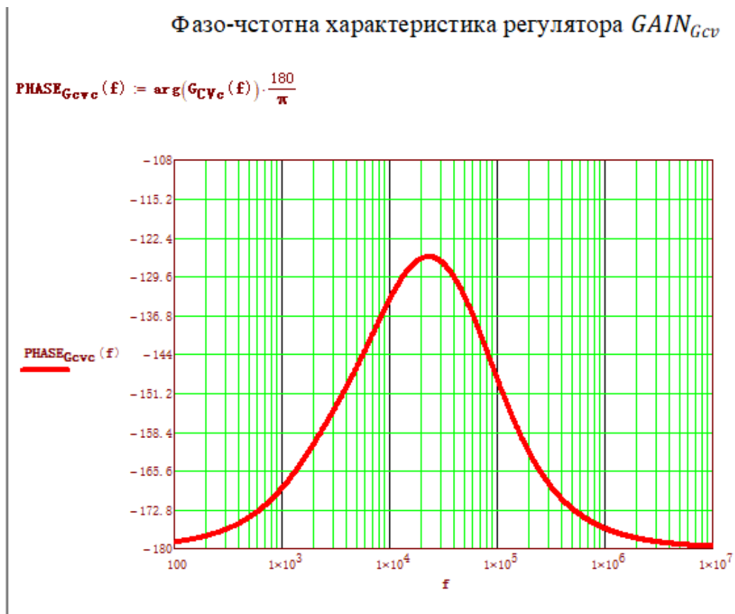
Рисунок 3.9 - Фазо-частотна характеристика передавальної функції регулятора G_{Cv} в середовищі MathCAD
