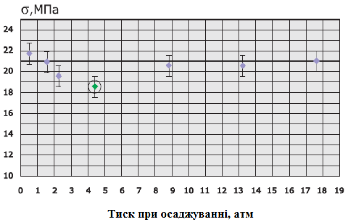
Рисунок 3.18 – Руйнівне напруження зварених з'єднань, отриманих при різних тисках при осаді
