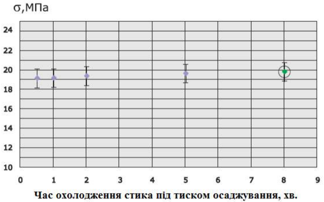
Рисунок 3.21 – Гранична напруга з'єднань отримані при різних значеннях часу охолодження
