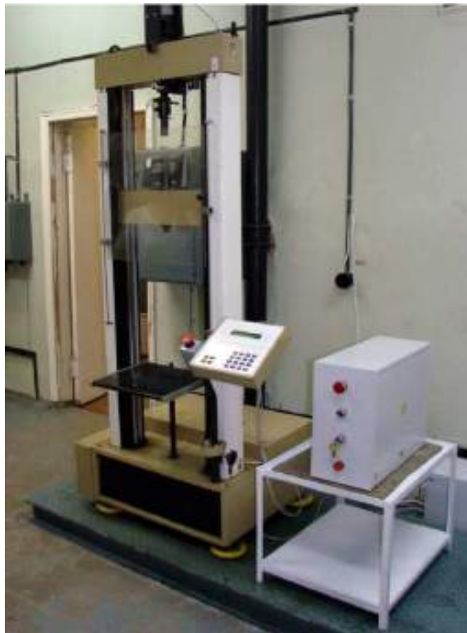
Рисунок 3.6 – Вимірювальний комплекс на базі розривної машини Р-50
