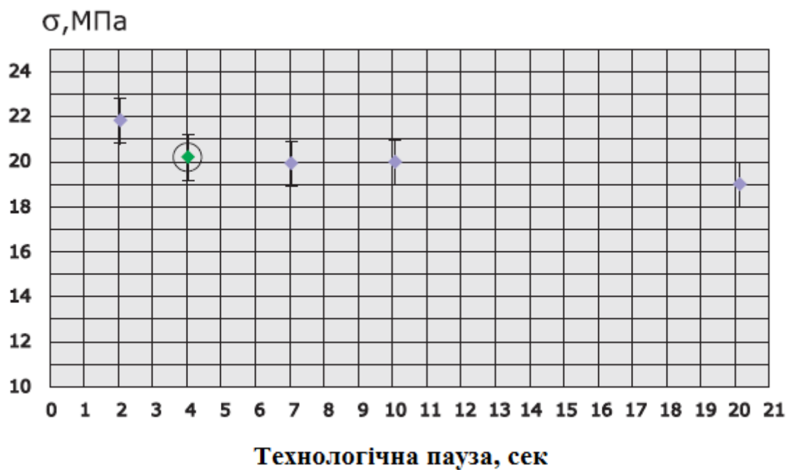
Рисунок 3.20 – Руйнівне напруження зварених з'єднань залежно від тривалості технологічної паузи
