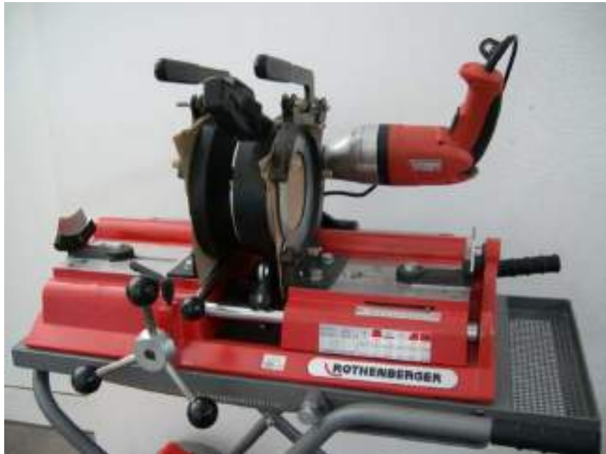
Рисунок 3.13 – Машина для стикового зварювання полімерних труб нагрівальним елементом Roweld P160 SANILINE, яка використовувалася при експериментальній зварюванні
