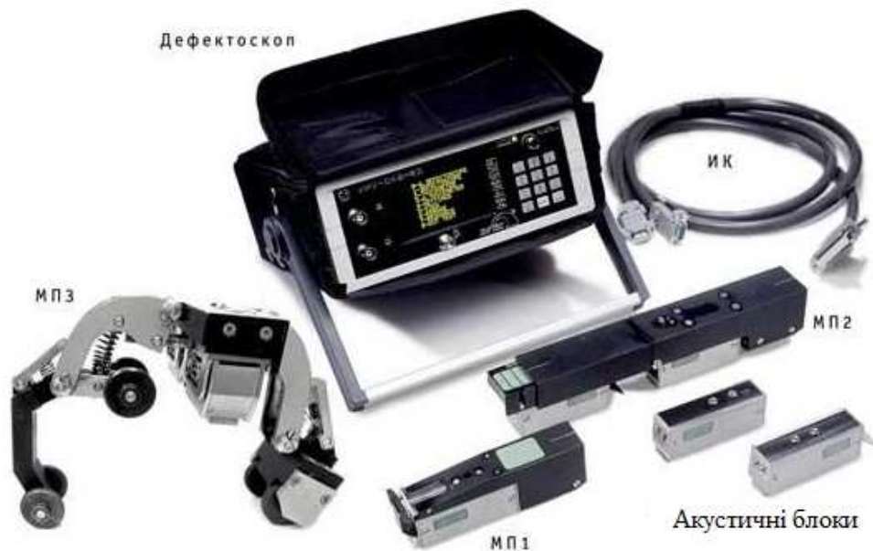
Рисунок 3.7 – Склад комплекту для ультразвукового контролю
