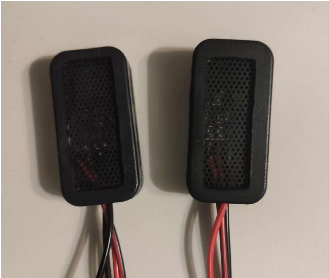
Рисунок 3.9 – Датчики температури та вологості в захисному корпусі з сіткою
