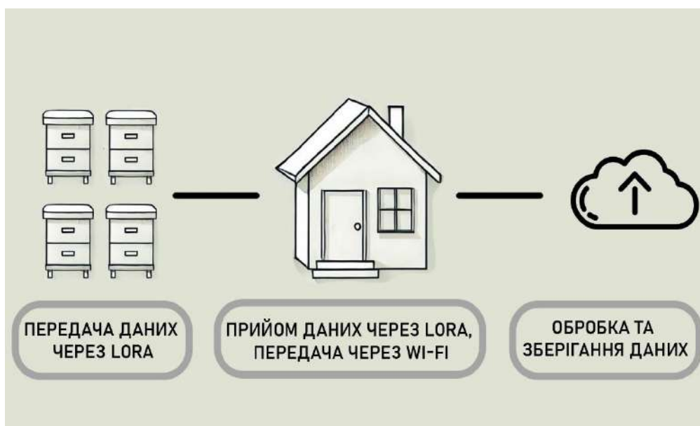
Рисунок 2.11 – Передача даних за допомогою технології LoRa
