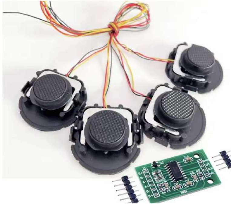
Рисунок 2.6 – Тензометричний підсилювач HX711 з тензодатчиками [94]
