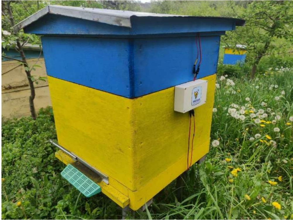
Рисунок 4.1 – Розміщення передавача на вулику
