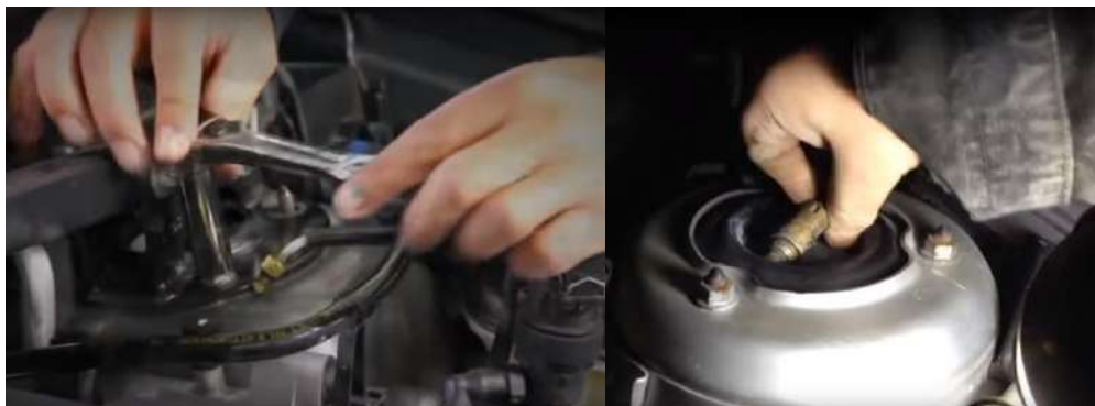
Рисунок 3.4 – Від'єднання клапану залишкового тиску
