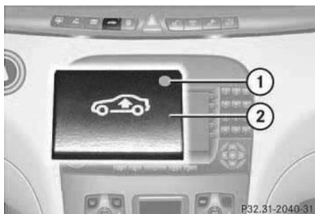
Рисунок 2.7 – Перемикач керування висотою кузова автомобіля
