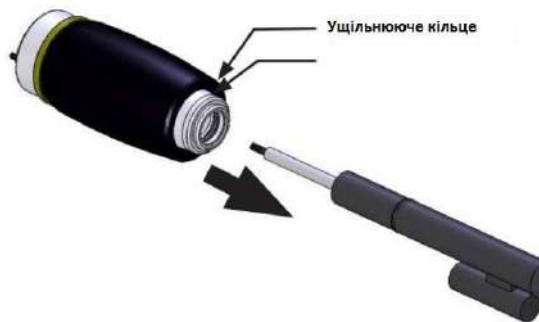
Рисунок 3.20 – Встановлення нового пневмобалону на амортизатор
