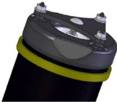
Рисунок 3.14 – Спеціальний знімач на шпильках з кріпленням
