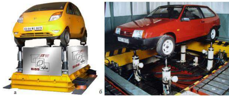
Рисунок 4.2 – Контрольно-випробувальні стенди для перевірки підвіски: а – сервогидравлічний стенд BiSS 4 Poster Rig; б – чотиривісний стенд фірми Shenck.
