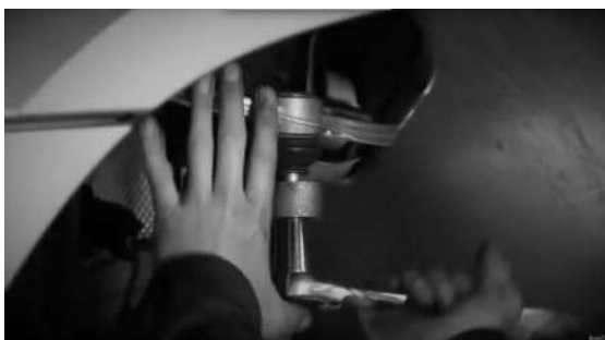
Рисунок 3.11 – Від'єднання верхньої частини амортизатора від верхнього важеля підвіски
