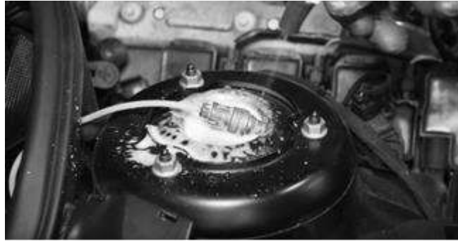
Рисунок 4.1 – Перевірка на герметичність амортизатора
