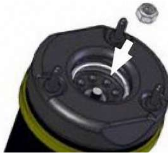
Рисунок 3.21 – Встановлення нового пневмобалону на амортизатор
